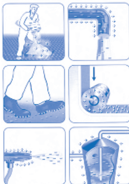
Obrázok 3.6: Príklady oddeľovania nábojov, ktoré môže viesť k vzniku elektrostatických nábojov 11
