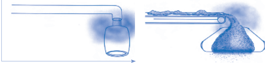
Obrázok 2.2: Príklady vzniku prachovzdušnej zmesi pri naplňaní alebo doprave 5
