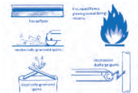
Obrázok 3.3: Príklady najbežnejších potenciálnych zdrojov vznietenia 10
