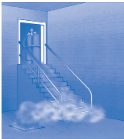
Obrázok 2.3: Šírenie skvapalnených plynov (príklad) 6
