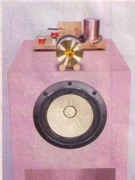
Im Experimentierstadium praktisch: Die Frequenzweiche ist hinter dem Hochtöner bestens zugänglich, der Austausch von Bauteilen problemlos möglich. Nach der Sturm-und-Drang-Phase wandert das Filternetzwerk an eine weniger auffällige Position, zum Beispiel auf die Rückwand oder in das Gehäuse.
