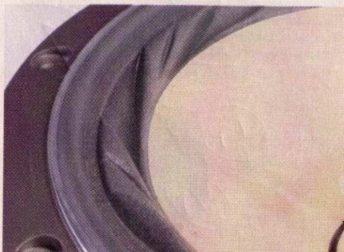
Die Schaumstoffsicke des Fostex-Breitbänders besitzt eine ähnliche Struktur wie die Zentrierspinne. Die Papiermischung der Membran enthält Fasern von Bananenstauden, die deren Stabilität und innere Dämpfung verbessern soll.
