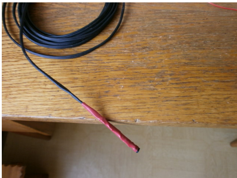
Měření teploty čidlem LM35D „ v prostoru místnosti“
